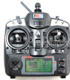
รูปที่ 2.6 รีโมทคอนโทรลที่ใช้งาน ส่งสัญญาณความถี่ 2.4 GHz
