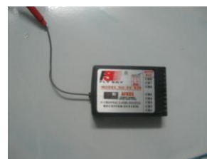
รูปที่ 2.7 ตัวรับสัญญาณที่ใช้รับสัญญาณความถี่ 2.4 GHz
