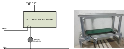
รูปที่ 2.7 วงจรสายพานลำเลียง และรูปสายพานลำเลียง
