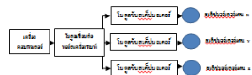
รูปที่ 2.1 บล็อกไดอะแกรมแสดงส่วนประกอบของชุดสาธิตเครื่องกัดชิ้นงาน
