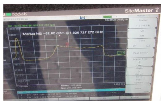
ภาพที่ 3-6 ภาพแสดงสัญญาณเมื่อผ่านวงจร PA ไปยัง สายอากาศ ค่าที่วัดได้ -62.62 dBm ที่ความถี่ 1820 MHz
