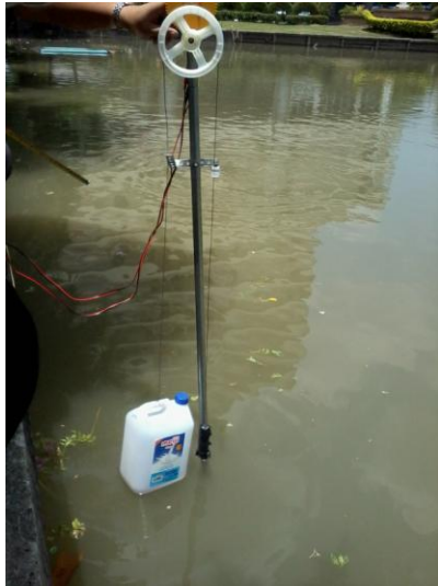
รูปที่ 3.8 ติดตั้งชุดวัดความสูงที่บ่อน้ำ
