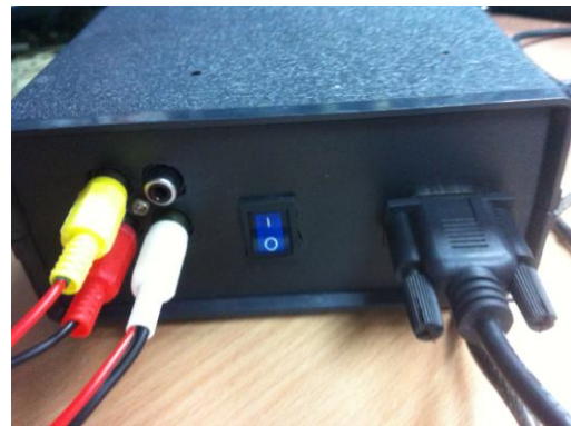
รูปที่3.6 เปิดสวิตซ์หลังชุดไมโครคอนโทรลเลอร์ที่สร้างขึ้น
