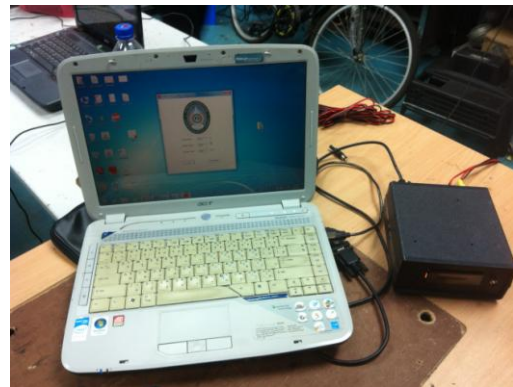
รูปที่3.5 การติดตั้งชุดไมโครคอนโทรลเลอร์ที่สร้างขึ้นกับคอมพิวเตอร์
