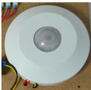
รูปที่ 3.11 เมื่อมีการตรวจจับการเคลื่อนไหวนอก จะแสดงการทำงานด้วย แอลอีดีสีแดง
