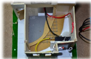
รูปที่ 3.3 การติดตั้งเดินสายระบบความปลอดภัยภายในอาคารแบบจำลอง
