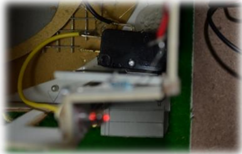
รูปที่ 3.6 ลักษณะของหน้าสัมผัสของสวิทช์ในขณะหน้าต่างปิดอยู่
