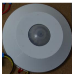
รูปที่ 3.13 เมื่อไม่มีการตรวจจับการเคลื่อนไหวนอก แอลอีดีสีแดงจะดับ
