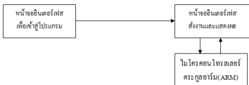
รูปที่ 2.2 บล็อกไดอะแกรมโครงสร้างของโปรแกรมที่พัฒนา
