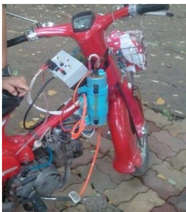
รูปที่ 3.10 การติดตั้งชุดควบคุมก๊าซไฮโดรเจน
