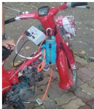
รูปที่ 3.13 การติดตั้งชุดควบคุมก๊าซไฮโดรเจน
