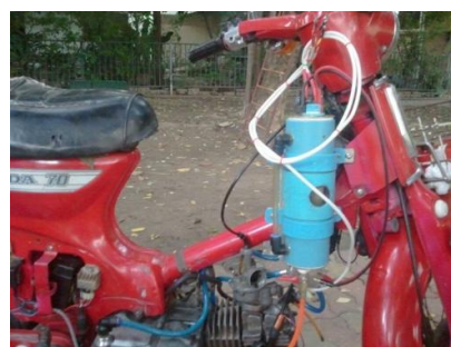
รูปที่ 3.9 การติดตั้งชุดผลิตผลิตก๊าซไฮโดรเจน
