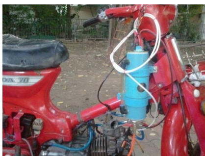
รูปที่ 3.12 การติดตั้งชุดผลิตผลิตก๊าซไฮโดรเจน
