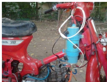
รูปที่ 3.1 การติดตั้งชุดผลิตผลิตก๊าซไฮโดรเจน
