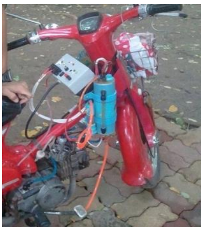
รูปที่ 3.6 การติดตั้งชุดควบคุมก๊าซไฮโดรเจน
