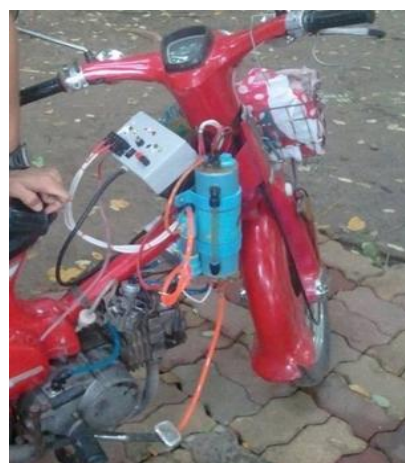
รูปที่ 3.2 การติดตั้งชุดควบคุมก๊าซไฮโดรเจน
