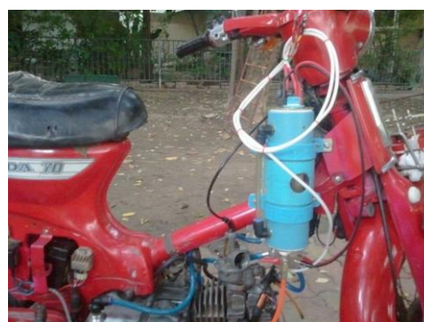
รูปที่ 3.5 การติดตั้งชุดผลิตผลิตก๊าซไฮโดรเจน
