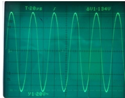
รูปที่ 3.4 แสดงการวัดสัญญาณเอาต์พุตของอัลตราโซนิค
