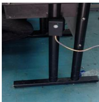
รูปที่ 3.7 การติดตั้งเซนเซอร์ตรวจจับความเคลื่อนไหว (PIR Motion Sensor)
