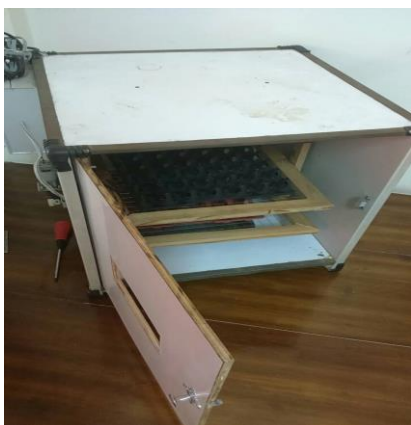
รูปที่ 3.1 ตู้ฟักไข่อัตโนมัติควบคุมด้วยไมโครคอนโทรลเลอร์
