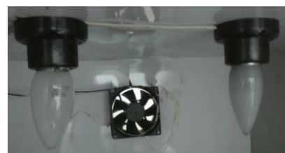
รูปที่ 2.5 ชุดหลอดไฟให้ความร้อน
