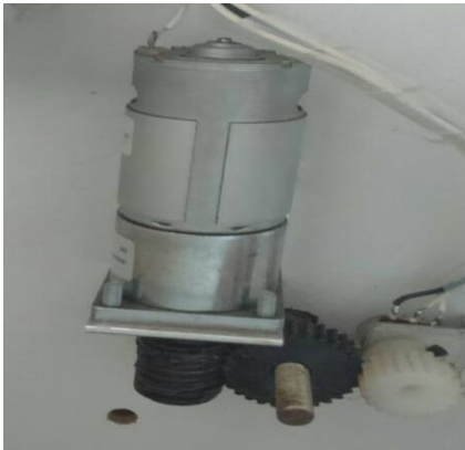
รูปที่ 3.7 มอเตอร์พลิกถาดรองไข่
